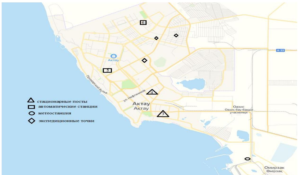
1 сурет – Ақтау қаласының атмосфералық ауа ластануын бақылау стационарлық желісінің және Эпизодтық бақылау нұктелерінің орналасу сызбасы
