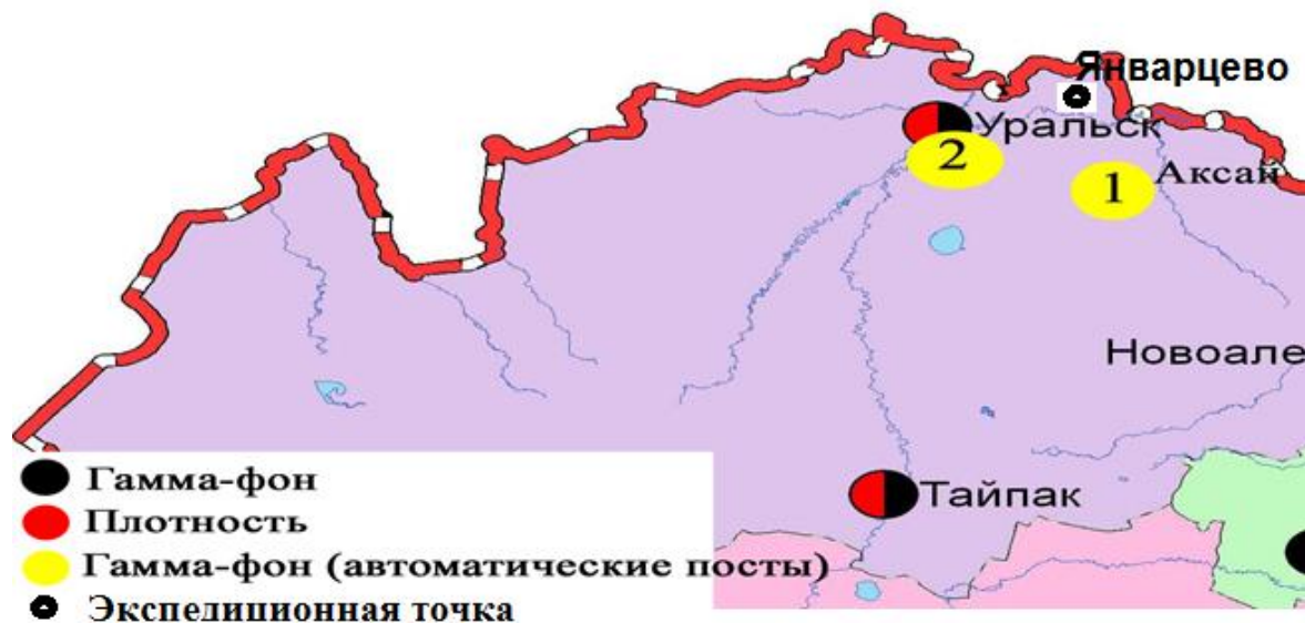
Күріш. 1 Аумақтағы радиациялық гамма-фонның деңгейін және радиоактивті төгінділердің тығыздығын бақылауға арналған метеорологиялық станциялардың схемасы Батыс Қазақстан облысы
