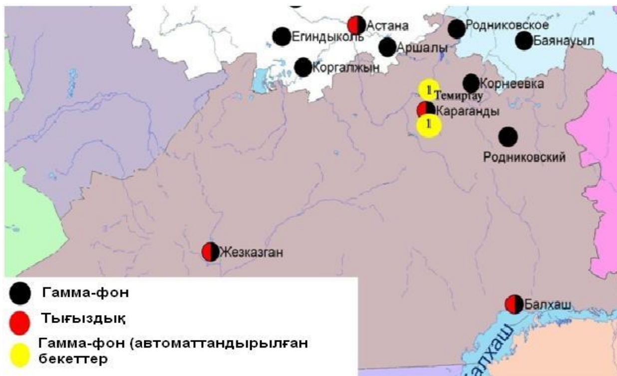
8.6 сур. Қарағанды облысының аумағындағы радиациялық гамма-фон мен радиоактивті түсулердің тығыздығын бақылау метеостансаларының орналасу сызбасы.
