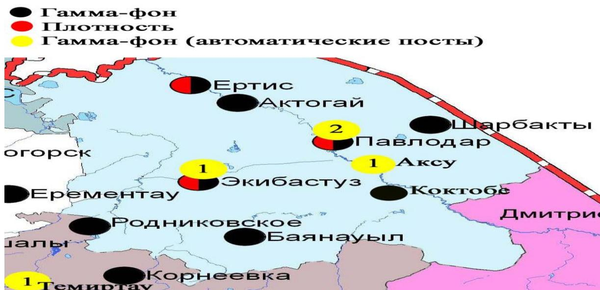
Рис. 12.4 Схема расположения метеостанций за наблюдением уровня радиационного гамма-фона и плотности радиоактивных выпадений на территории Павлодарской области
