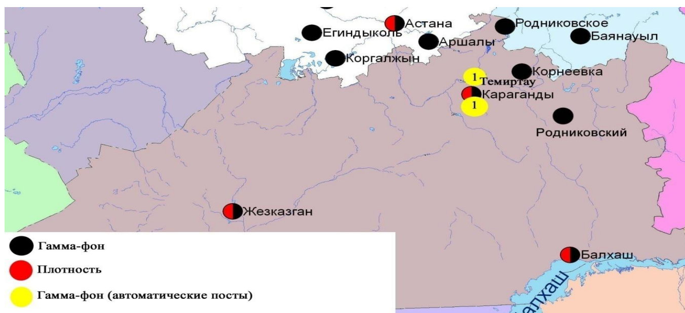
Рис. 8.7 Схема расположения метеостанций за наблюдением уровня радиационного гамма-фона и плотности радиоактивных выпадений на территории Карагандинской области
