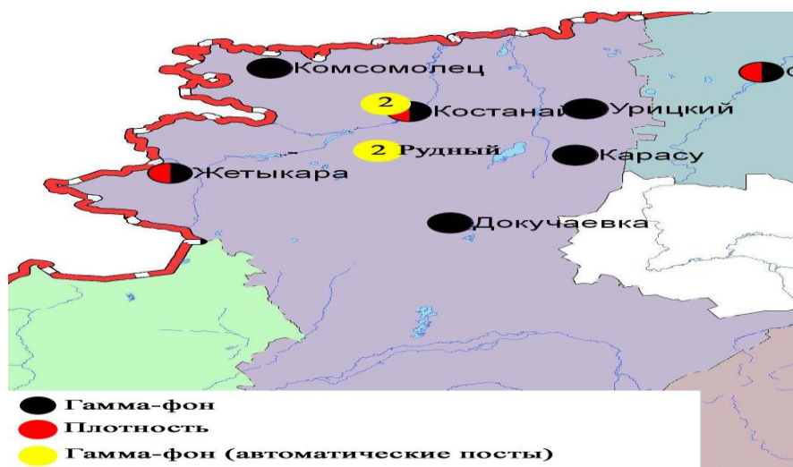
Рис. 9.5 Схема расположения метеостанций за наблюдением уровня радиационного гамма-фона и плотности радиоактивных выпадений на территории Костанайской области
