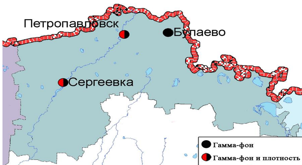
Рис. 13.3 Схема расположения метеостанций за наблюдением уровня радиационного гамма-фона и плотности радиоактивных выпадений на территории Северо-Казахстанской области
