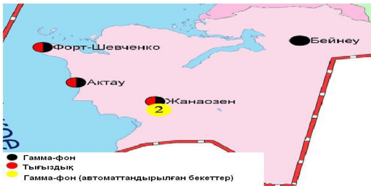
11.12 сур. Маңғыстау облысының аумағындағы радиациялық гамма-фон мен радиоактивті түсулердің тығыздығын бақылау метеостансаларының орналасу сызбасы.
