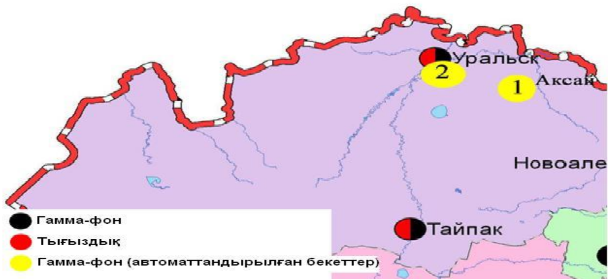
1-сур. Батыс Қазақстан облысының аумағындағы радиациялық гамма-фон мен радиоактивті түсулердің тығыздығын бақылау метеостансаларының орналасу сызбасы
