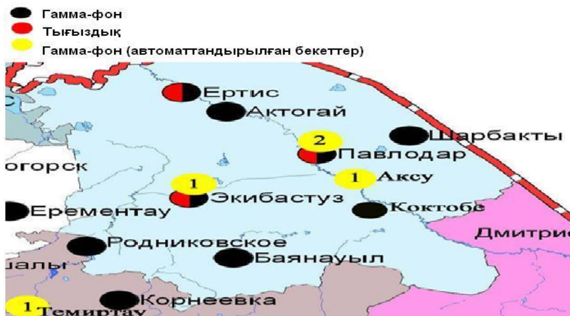
4-сурет. Павлодар облысының аумағындағы радиациялық гамма-фон мен радиоактивтітүсулердің тығыздығын бақылау метеостансаларының орналасу сызбасы
