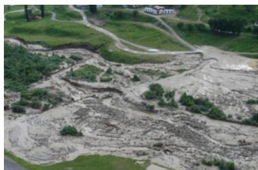
В результате прохождения селя была разрушена и перекрыта селевыми отложениями дорога к поселку ГЭС-2, дорога Алматы – ГЭС-1 была размыва на двух участках, разрушены 2 мостовых перехода и 2 железобетонных моста, повреждена селенаправляющая дамба в районе ГЭС-1. Проводилась эвакуация отдыхающих (более 50 человек) силами Казселезащиты и РОСО МЧС РК.
