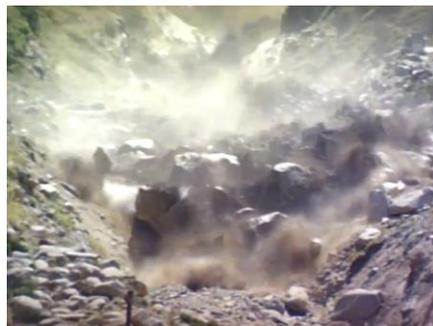
В ходе экспериментов водный поток с расходом 28 м<sup>3</sup>/с трансформировался в грязекаменный поток с расходом 430 м<sup>3</sup>/с и плотностью селевой массы около 2400 кг/м<sup>3</sup>. На верхнем снимке показан водный поток, движущийся к селевому очагу. На нижнем снимке – фронтальная часть селя на выходе из селевого очага. Результаты экспериментов внесли крупный вклад в мировую науку о селях. Фильм и краткое описание об этих экспериментах можно посмотреть и почитать, перейдя по ссылке
