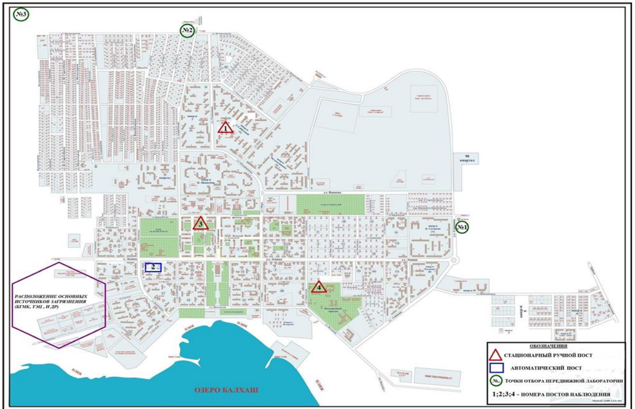
Балқаш қаласындағы атмосфералық ауа ластануың анықтайтын стационарлық бақылау жүйесінің сызбасы
