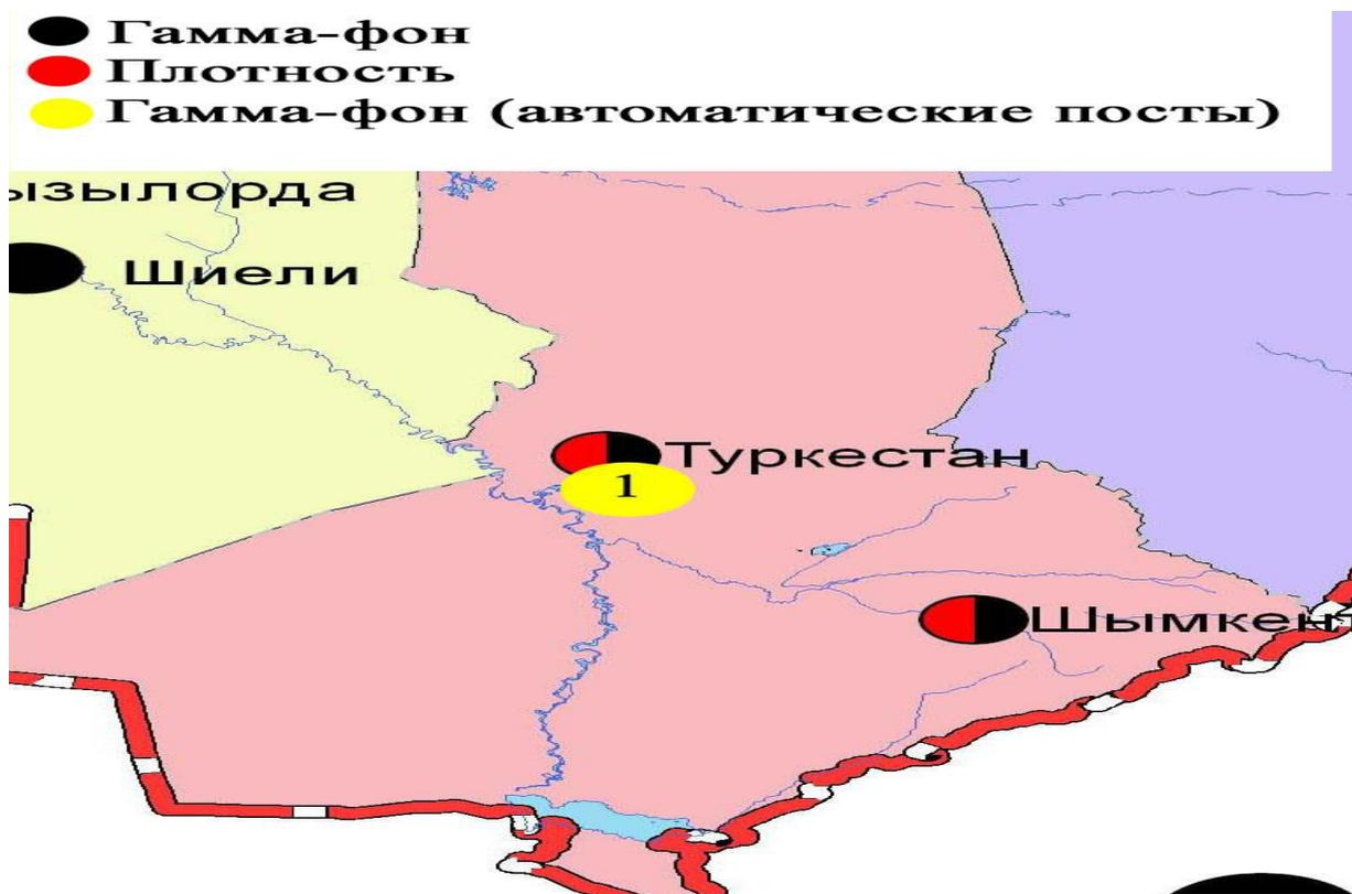
Рис. 14.4 Схема расположения метеостанций за наблюдением уровня радиационного гамма-фона и плотности радиоактивных выпадений на территории Южно-Казахстанской области
